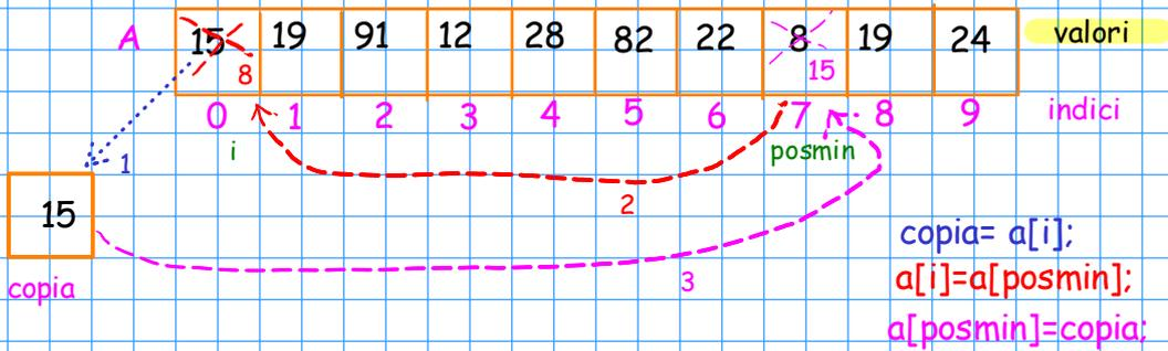
configurazione del vettore dopo il primo scambio
